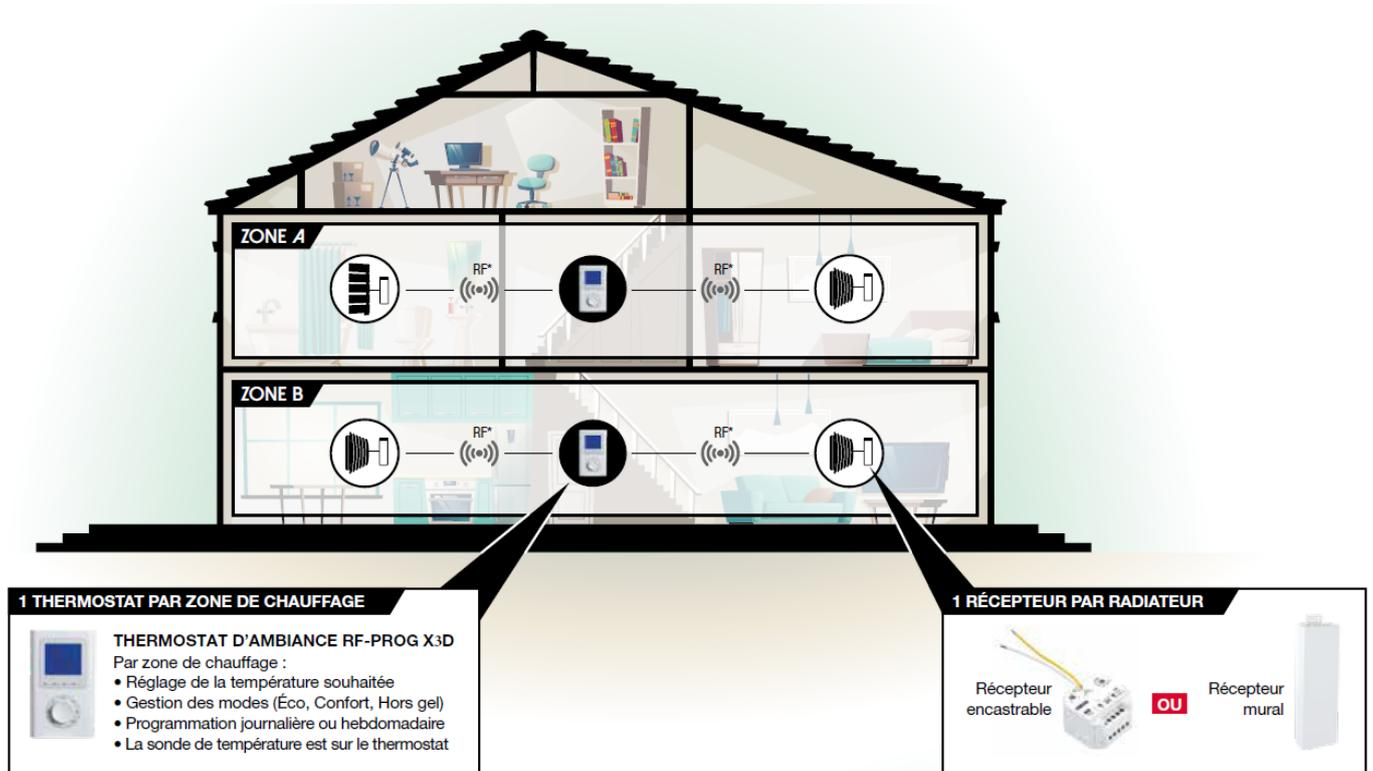
Positionnés dans la pièce, les thermostats d'ambiance sans fil permettent de réguler, de façon plus précise et plus souple, la température intérieure de l'habitat en communiquant avec le récepteur mural ou encastrable dans l'appareil.
