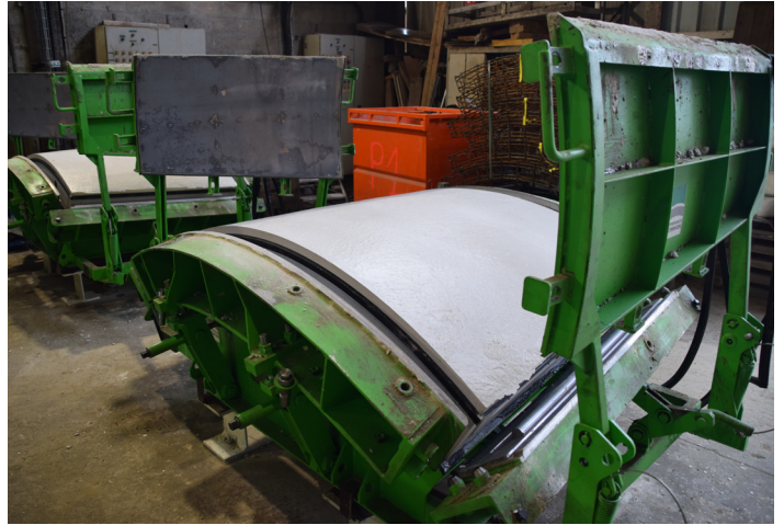
Moule ouvert en attente du décoffrage
