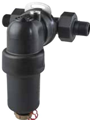
Pour garantir une protection continue des pompes à chaleur, WATTS propose le nouveau séparateur de boues magnétique S360 en corps composite (polyamide PA 66 renforcé). Spécialement conçu pour les PAC grâce à son fort débit (5000 L/h), il retient les impuretés et empêche leur circulation.
