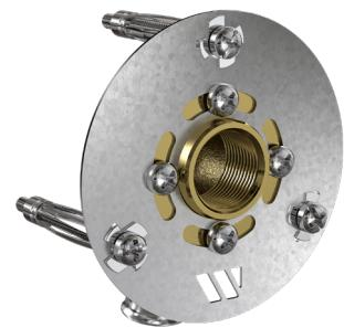
Facile à poser dans sa précédente version, ROBIFIX® MONO est encore plus rapide à fixer. Grâce à une cheville à expansion de moins et à une mise à niveau inutile pour ce format circulaire, il garantit une accroche parfaite de la plaque-support dans la cloison. A cela s'ajoute une précision du diamètre de perçage. Il suffit au plombier de percer un trou de 44 mm à l'aide d'une scie cloche, de sertir le raccord, d'emboîter la platine et le tour est joué !
